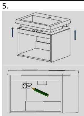
5. Soulever le meuble contre la table. Alignez avec le niveau à bulle et contrôlez aussi la position de la table. Tracez les trous pour la fixation du meuble et remplacez le meuble.
