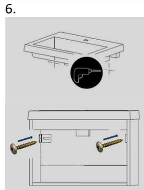
6. Percez les trous pour les vis de montage avec une mèche de diamètre 10 mm. Insérez les tampons et remplacez le meuble sous la table. Fixez le meuble avec les vis fournies.
