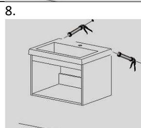
8. Faites un joint d'étanchéité en silicone entre le mur et la table.
