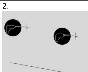
2. Percez les trous pour les vis de montage. Les vis et tampons ne sont pas fournis !
