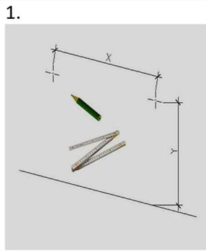
1. Tracez les trous pour les vis de montage de la table et mesurez l'entraxe. La hauteur pour le raccordement est mentionnée sur le plan (peut varier selon la situation sur place).
