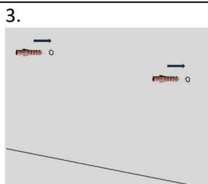
3. Insérez les tampons avec un marteau jusqu'à affleurage avec la paroi. Attention à ne pas endommager la paroi.
