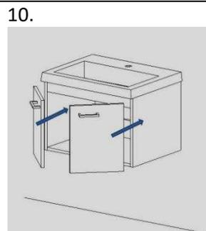
10. Accrochez les portes sur le meuble. Les faces peuvent être réglées dans les 3 dimensions avec les 3 vis visibles sur les charnières si nécessaire.
