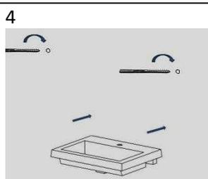
4. Vissez les vis dans le mur et accrochez la table. Ne pas serrer les vis !
